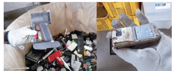
▲「燃やせないごみ」に混入した充電式小型家電の例 これらを人の手で選別して事故を防いでいます
